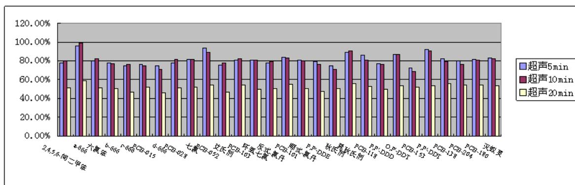
图4 不同超声时间对目标化合物回收率的影响
