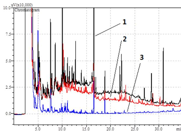
图 6 沉积物样品不同净化方法的比较
