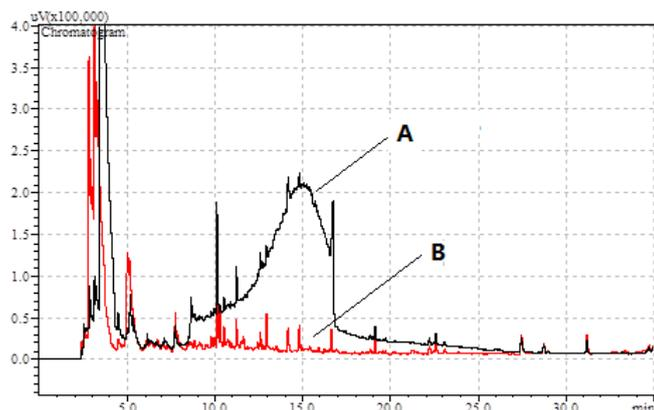
图3 铜粉对沉积物样品除硫效果的影响
