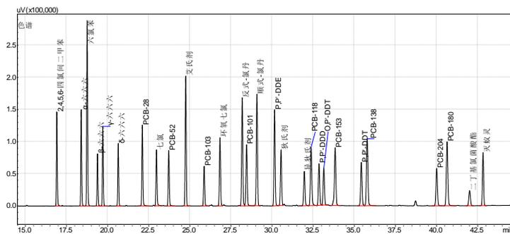
图 8 24 种目标化合物、2 种替代物及 2 种内标物的 GC-ECD 色谱图，浓度为 100 ng/mL
