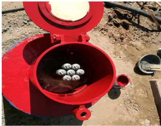
图 2-5 国内 7 层集束式监测井（捆绑式）
