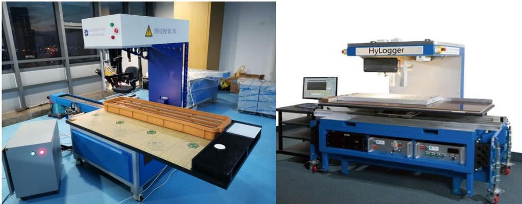
图 CMS350B 型岩心图像及光谱扫描仪（左）和 Hylogger 岩心综合扫描仪（右）
